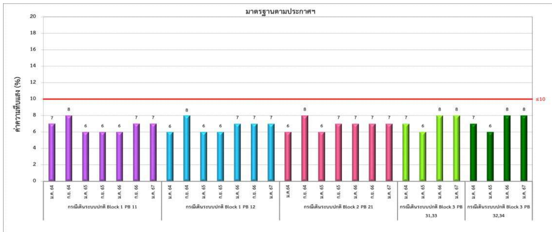
รูปที่ 3-18 เปรียบเทียบผลการติดตามตรวจสอบค่าความทึบแสง กรณีเดินระบบปกติ (Normal Operation) ตามประกาศฯ ระหว่างปี พ.ศ. 2564-2567
